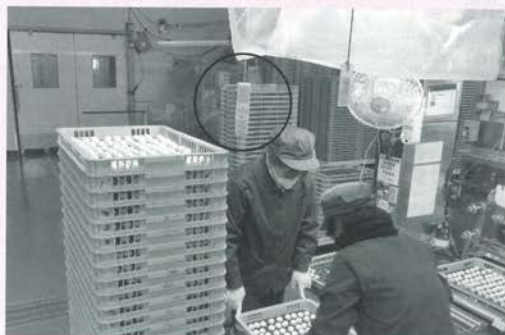
吊り下げた目印(○部)で30段の積み上がりが目際瞭然
