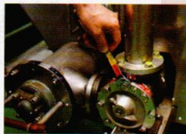
工具とボルトを色分けし、ボルトを締めるときにどの工具を使うかが一目で分かるようにしている。「お金をかけずに密着化」を徹底するのが基本的な考え方だ
