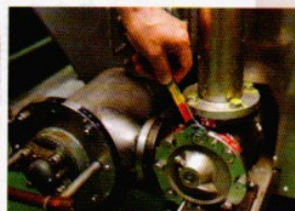
工具とボルトを色分けし、ボルトを締めるときにどの工具を使うかが一目で分かるようにしている。「お金をかけずに密着化」を徹底するのが基本的な考え方だ
