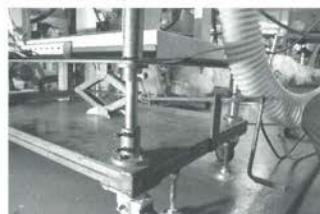
使用する容器の高さに合わせて、計量器の高さを調節できる
